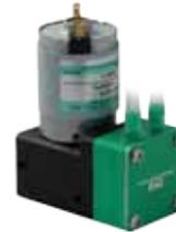
Die selbstansaugenden Membranpumpen der Serien DAP und DBP mit Förderraten von 500 ml/min, bei Betriebsdruckbereichen von -600 bis 1000 mbar, bieten einige Vorteile.
