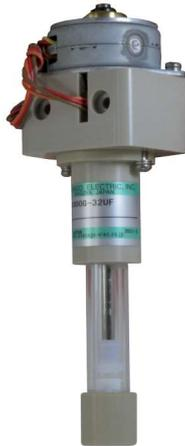
Diese Spritzenpumpen sind mit einem 2-Phasen-Bipolar-Schrittmotor ausgestattet und bestehen durch eine geringe Bauform von nur 26 x 42 x 120 mm bei Kapazitäten von 100 µl bis 1000 µl.
