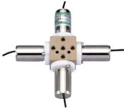
Dieses 4-Wege-Manifold-Ventil, welches speziell für Niederdruck-Gradientenmischer entwickelt wurde, führt alle vier Eingänge auf einen gemeinsamen Ausgang. Die vier Eingänge lassen sich über einzelne Magnetventile ansteuern, um die benötigten Mischverhältnisse zu erzeugen. Da die Länge der einzelnen Kanäle zu dem gemeinsamen Ausgang gleich ist, wird eine sehr hohe Genauigkeit des Mischverhältnisses erreicht.
