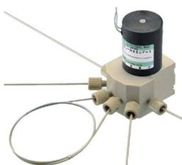
Dieses Ventil mit 2-Positionen und 6-Anschlüssen ist das erste Magnetventil zum Injizieren von Proben, welches über einen Linearaktor angesteuert wird.
