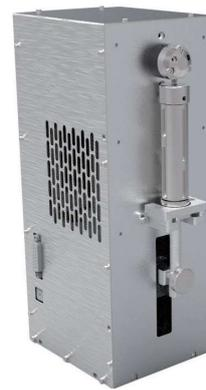
Diese hochpräzisen Spritzenpumpen ermöglichen eine genaue Dosierung mit < 1% Genauigkeit bei hohen Drücken. Die MPSP-Serie dosiert gegen Drücke von bis zu 20 bar und kann mit einem 2- oder 6-fach Selektionsventil aus 316-Edelstahl oder PEEK ausgestattet werden. Die Hochdruck-Spritzenpumpe der HPSP-Serie fördert gegen Drücke von bis zu 60 bar und ist mit einem Edelstahl 2-fach Selektionsventil verfügbar.
