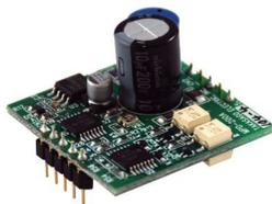
Das MPD-200A ist ein kompaktes Driver Board. Es ist eine Hochspannungsleiterplatte, spezifisch entwickelt für die piezoelektrischen Mikropumpen. Aus einer 5 VDC Eingangsspannung erzeugt es die nötige Ausgangsspannung von 250 Vp-p. 40 Hz, um die Pumpe zu betreiben.
