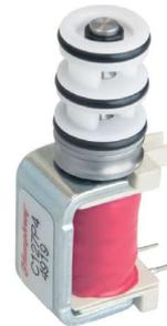
2/2-Wege und 3/2-Wege Ventile in kompakter Bauweise und hohem Durchfluss von bis zu 40 l/min (10mm Ventil bei 2 bar), bzw. 125 l/min (12mm Ventil bei 2 bar). Die Ventile sind druckausgeglichen und erlauben einen maximalen Druck von bis zu 2 bar auf allen Anschlüssen. Schnelle Schaltzeiten ermöglichen eine präzise Steuerung von Luft, Sauerstoff und inerten Gasen.
